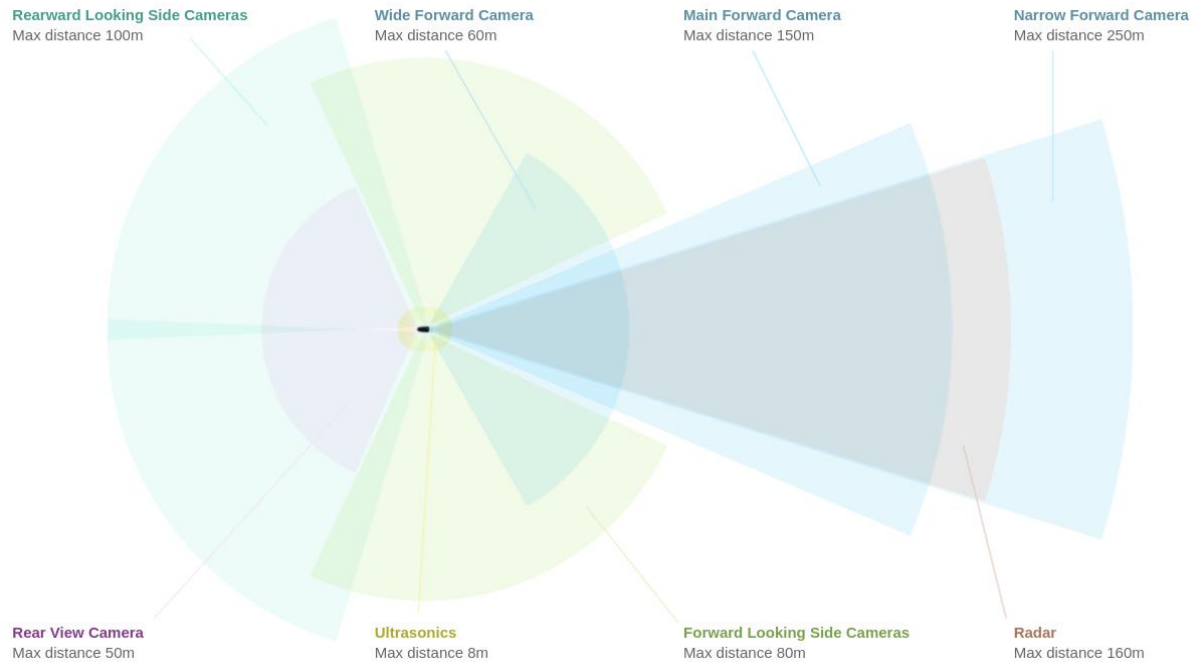
Joonis 1. Tesla autole paigutatud sensorite tööraadiused
