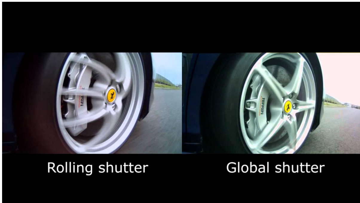
Joonis 3. Rolling shutter ja Global shutter kaamerate pildi võrdlus.
